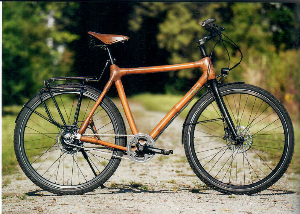
Der Rahmen ist handgemacht in einem sozialen Projekt in Ghana. Unten: Passen sauber zusammen: Rohloff und Bambus.
